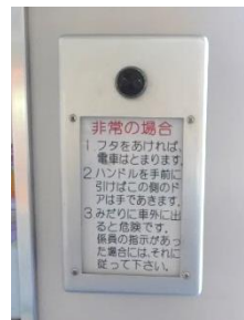
非常通報装置
